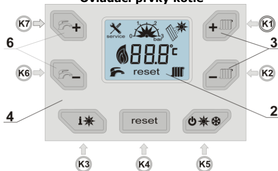
Obrázek 2.2.1.2 Uspořádání součástí v jednofunkčním kotli Ecocondens Crystal Plus 50
